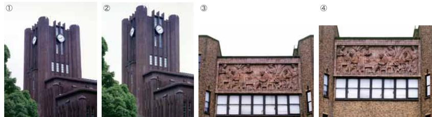
①東京大学・安田講堂を撮影しようとして大判カメラを構えましたが講堂全体が構図出来ないためにカメラを上に向けてアオリを掛けずにそのまま撮影しました。②講堂の垂直線が斜めのためバックアオリを使い、垂直線を修整し、更にフロントアオリでピント面も修整して撮影しました。
