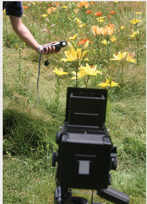
入射式露出計。被写体に近づける場合は、カメラに光球を向けて計る
